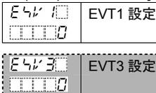
左側上段は ORP 表示器で設定(選択)項目キャラクタを、左側下段は設定表示器で工場出荷初期値を表しています。右側は設定(選択)項目名を表しています。
