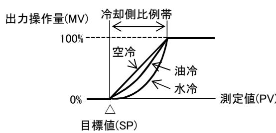
冷却方式の出力特性動作図
