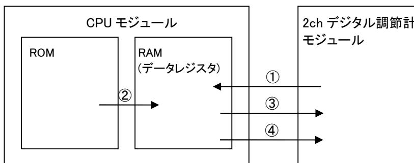
① : パラメータ読み出しビットをOFF→ONしたときのパラメータデータの流れ
