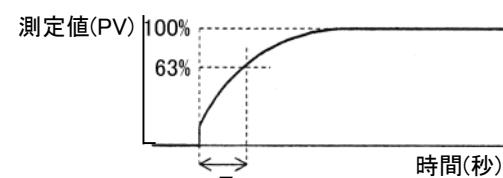
図2 PVフィルタ処理後の測定値(PV)
