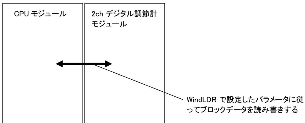
2chデジタル調節計モジュールのパラメータは、機能と使用頻度に応じて下表に示す26個のブロックで構成されます。使用するすべてのブロックはCPUモジュールのデータレジスタに割り当てられます。内部リレーに割り当てる制御リレーを使うことで、2chデジタル調節計モジュールに対し、各ブロックのパラメータの読み出しと書き込みを行うことができます。
