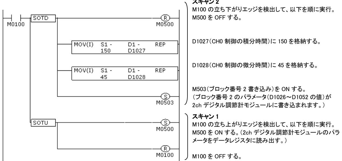
※1: パラメータ読み出し(M500)を ON すると、2ch デジタル調節計モジュールのパラメータがデータレジスタに読み出されます。このとき、ブロック番号 2 のパラメータは、D1026～D1052(先頭データレジスタを D1000 とした場合)に格納されます。
