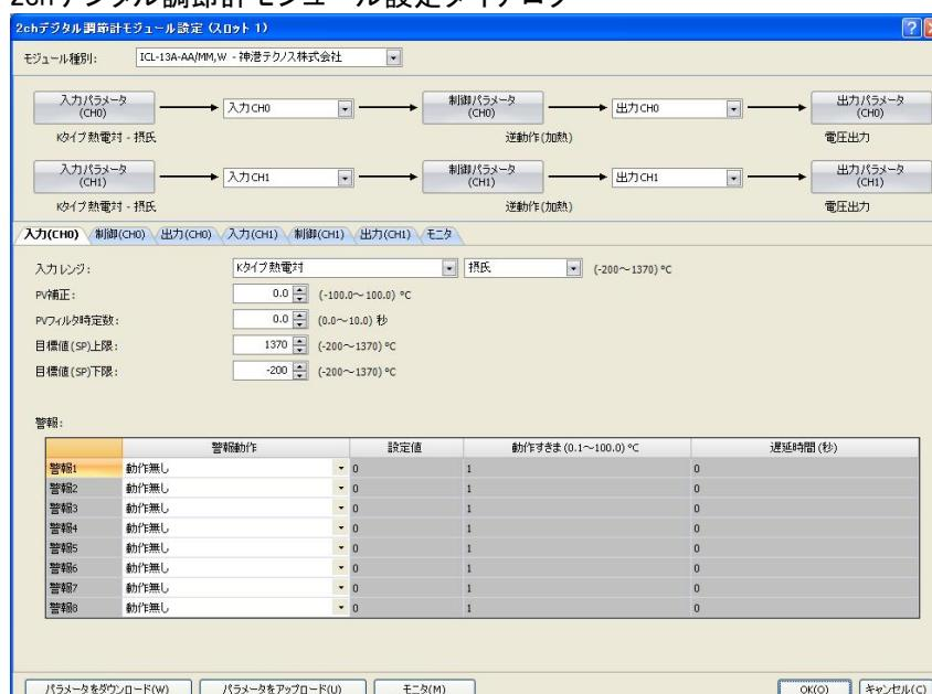
2chデジタル調節計モジュールの全てのパラメータがこのダイアログで設定できます。必要なパラメータを設定し、OKボタンをクリックしてダイアログを閉じます。
