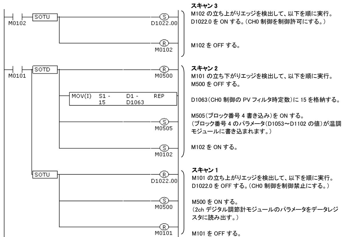
※1: パラメータ読み出し(M500)を ON すると、2ch デジタル調節計モジュールのパラメータがデータレジスタに読み出されます。このとき、ブロック番号 4 のパラメータは、D1053～D1102(先頭データレジスタを D1000 とした場合)に格納されます。
