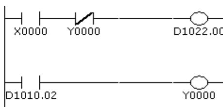
外部入力 X0 が ON のとき、CH0 制御を制御許可にします。Y0 (CH0 制御のループ異常警報出力)が ON の時、制御禁止にします。
