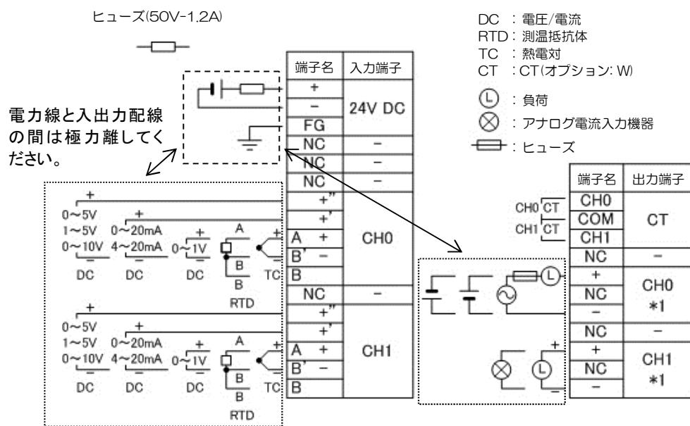
\*1: CH0:リレー出力、CH1:無接点電圧/電流出力の接続例を示しています。両方の出力仕様を持つた機種は存在しません。
