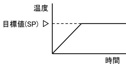
プログラム制御は、時間の経過に伴って変化する目標値(SP)に測定値(PV)を追従させるように調節動作を行います。目標値(SP)と時間はステップ毎に設定でき、最大 10 ステップ分の制御を連続して行います。目標値(SP)は下図のように設定できます。
