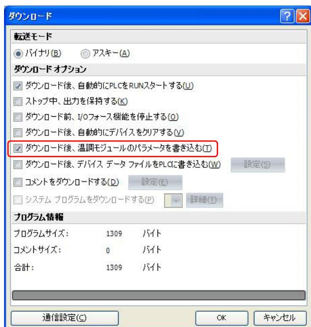
“ダウンロード後、温調モジュールのパラメータを書き込む”に✓を入れた場合、ユーザプログラムをCPUモジュールにダウンロードした後、“2chデジタル調節計モジュール設定”ダイアログ上で設定したパラメータを、“増設モジュール設定”ダイアログで設定したスロット番号の2chデジタル調節計モジュールとCPUモジュールのデータレジスタに書き込みます。
