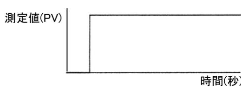
図1 PVフィルタ処理前の測定値(PV)
