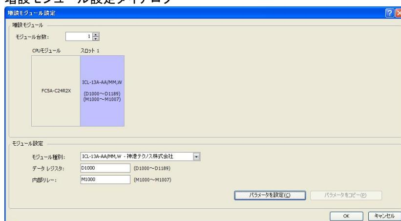
モジュール台数および2chデジタル調節計モジュールが接続されているスロット番号を選択後、モジュール種別を選択し、制御レジスタ(データレジスタ)および制御リレー(内部リレー)を指定します。モジュール設定後、[パラメータを設定]ボタンをクリックし、2chデジタル調節計モジュール設定ダイアログを開きます。
