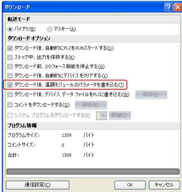
[ダウンロード後、温調モジュールのパラメータを書き込む]をチェックし、OKボタンを押して、ユーザプログラムをダウンロードします。ユーザプログラムのダウンロード後に、2chデジタル調節計モジュールのパラメータが自動的にデータレジスタとCPUモジュールに接続されている2chデジタル調節計モジュールに書き込まれます。
