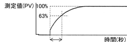
図 2 PV フィルタ処理後の測定値(PV)
