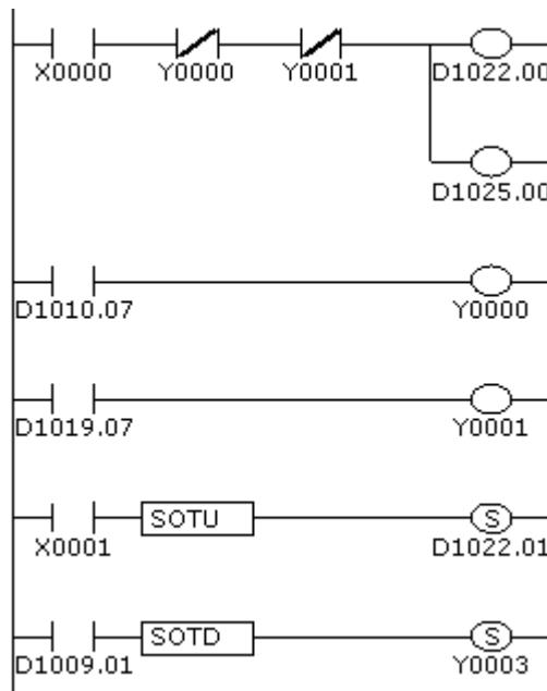
外部入力 X0 が ON のとき、2ch デジタル調節計モジュールを制御許可にします。Y0 (CH0 制御の上限警報出力) が ON または Y1 (CH1 制御の上限警報出力) が ON の時、制御禁止にします。
