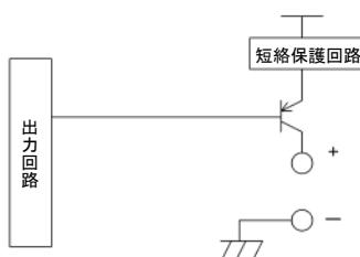
ICL-13A-AA/MM(電流出力)
