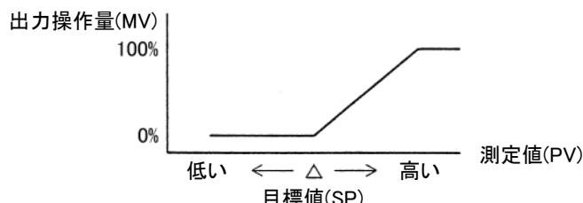
逆動作は、測定値(PV)が目標値(SP)より低い場合(負の偏差)に対して出力操作量(MV)を増やすように動作します。電気炉などがこの動作にあたります。
