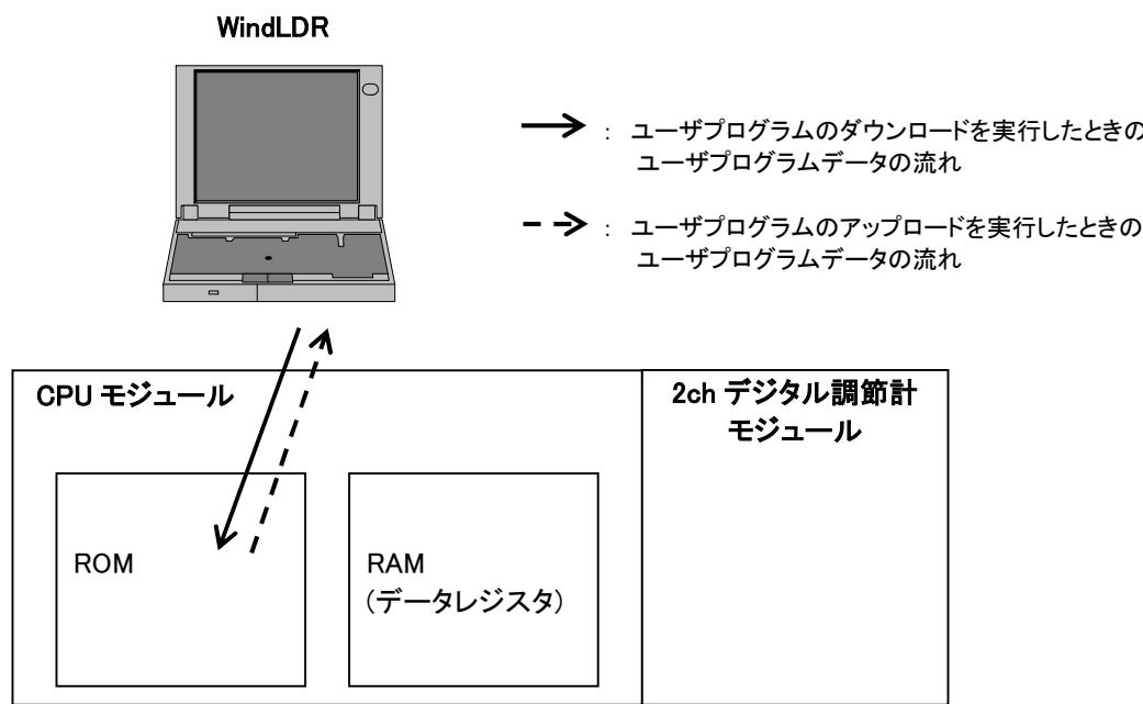
※1: “ダウンロード”ダイアログ上で、“ダウンロード後、温調モジュールのパラメータを書き込む”に✓を入れた場合、ユーザプログラムを CPU モジュールにダウンロードした後、パラメータダウンロードを実行します。
