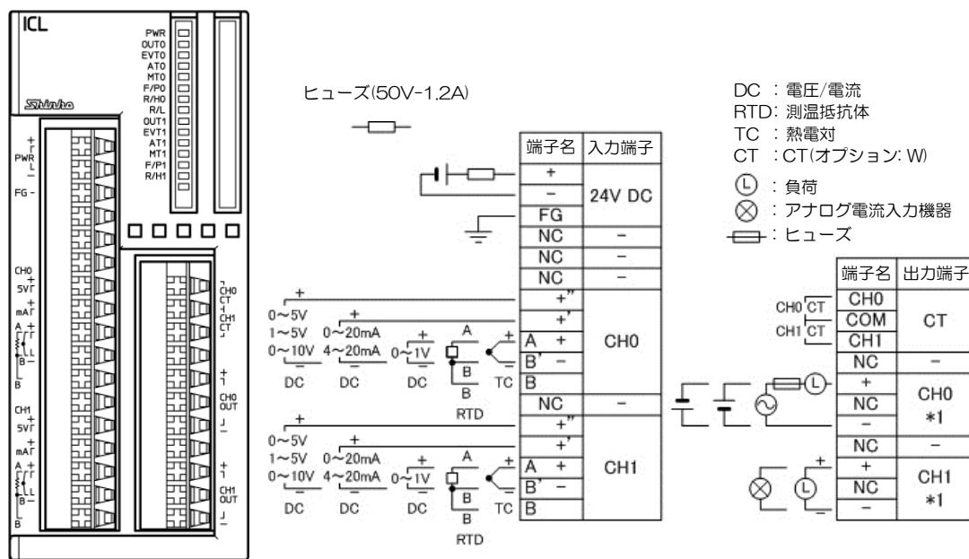
\*1: CH0:リレー出力、CH1:無接点電圧/電流出力の接続例を示しています。両方の出力仕様を持った機種は存在しません。
