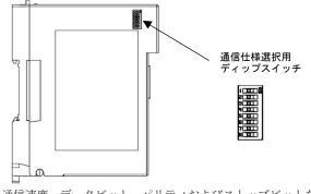
通信速度,データビット,パリティおよびストップビットを選択してください。工場出荷時は、全てOFFです。
