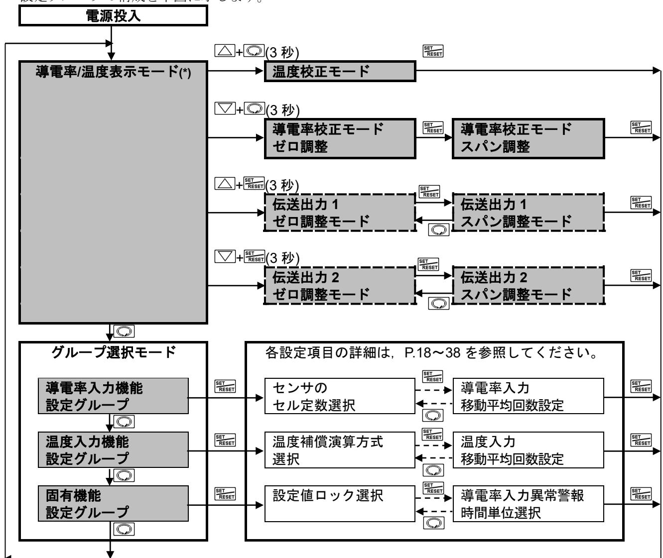
(\*): 導電率/温度表示モード時、[表示器選択(P.34)]で選択した項目を表示します。
