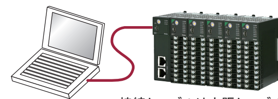
接続ケーブルは市販ケーブル (microUSB・タイプB)を使用できます。
