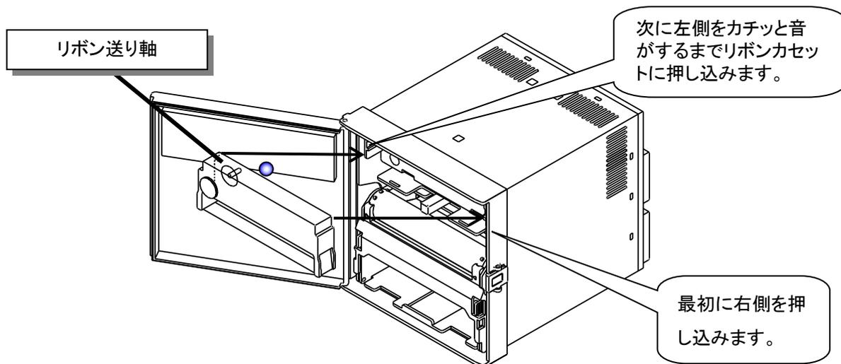
図 5.14 リボンカセットを取り付ける
