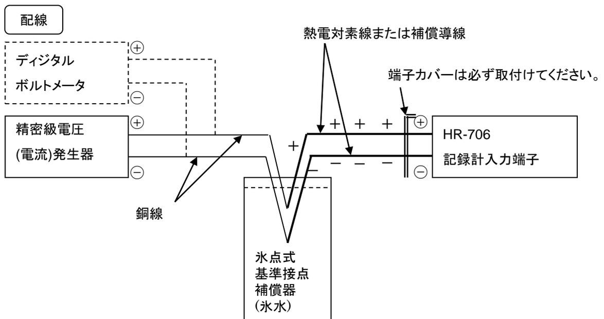
[設定例] チャンネル 1 に入力を接続し熱電対入力表示値(0°C 入力時の測定値)が $-0.5^{\circ}\text{C}$ 、測定端子温度が $24.5^{\circ}\text{C}$ の場合の校正を設定する。
