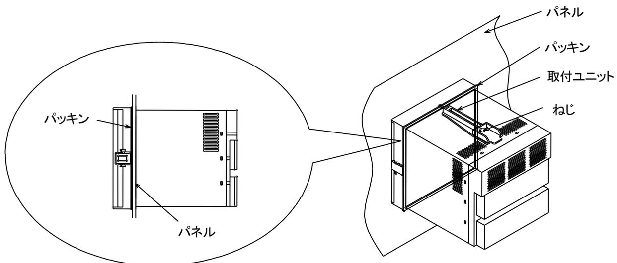
図 3.4 パネルへの取付方法(IP65 対応時)
