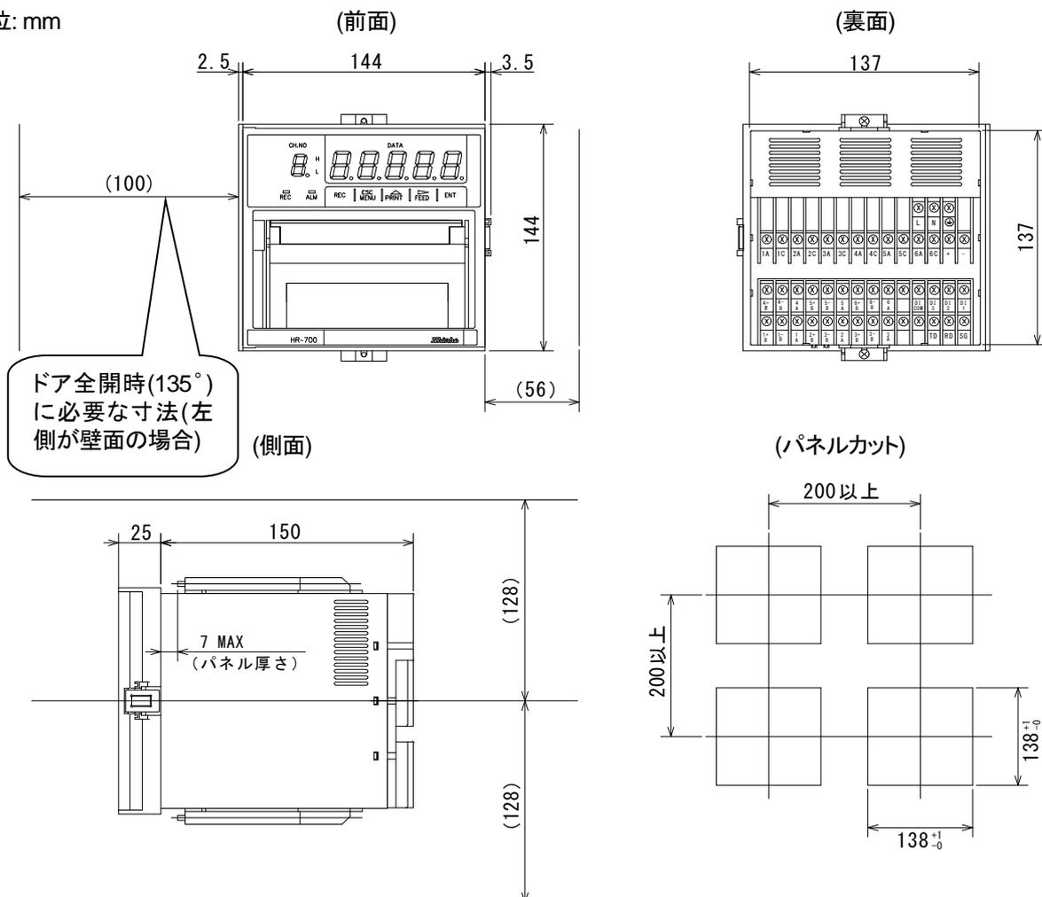
図 3.1 外形寸法及びパネルカット寸法
