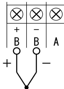
図 4.4 入力配線(mV, V 入力, 熱電対入力の場合)
