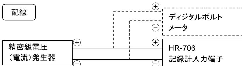
エンジニアリングモードのデータキャリブレーション(電圧校正)に従い校正を行ってください。
