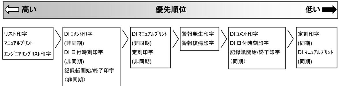
“同期印字”はアナログ記録に同期してデジタル印字するもので“非同期印字”はアナログ記録を中断してデジタル印字を実行し、印字完了後アナログ記録を再開するものです。
