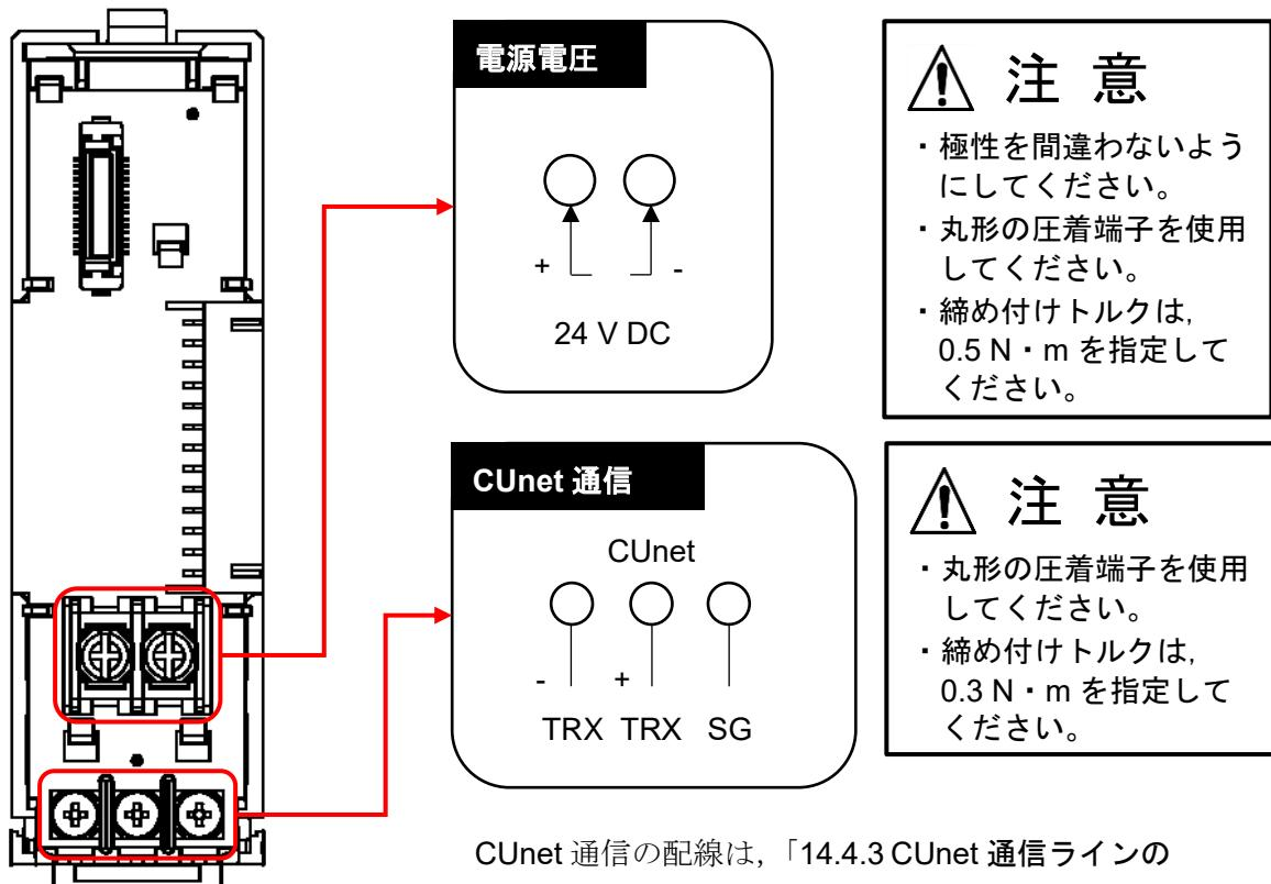
CUnet 通信の配線は、「14.4.3 CUnet 通信ラインの配線例」(P.14-10)を参照してください。
