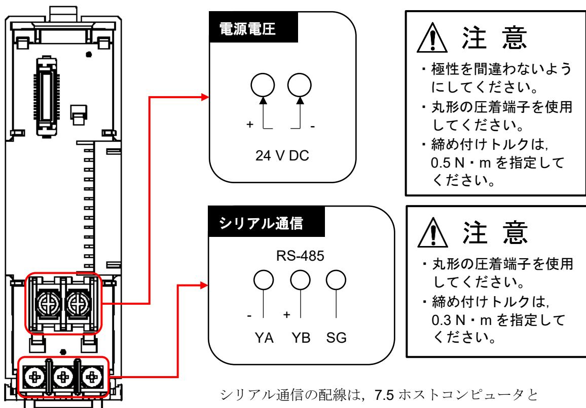
シリアル通信の配線は、7.5 ホストコンピュータと制御モジュール QTC1-4 の接続(P.7-12)を参照してください。
