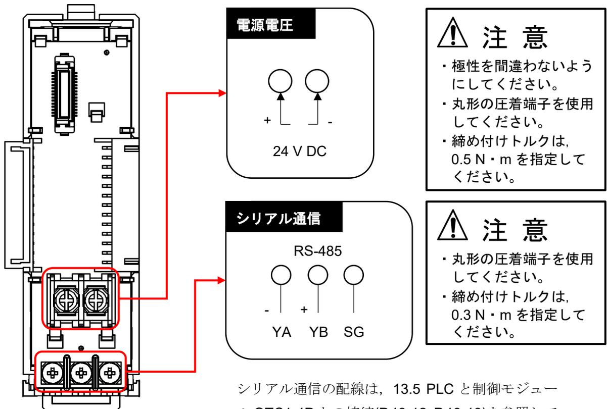
シリアル通信の配線は、13.5 PLC と制御モジュール QTC1-4P との接続(P.13-12, P.13-13)を参照してください。
