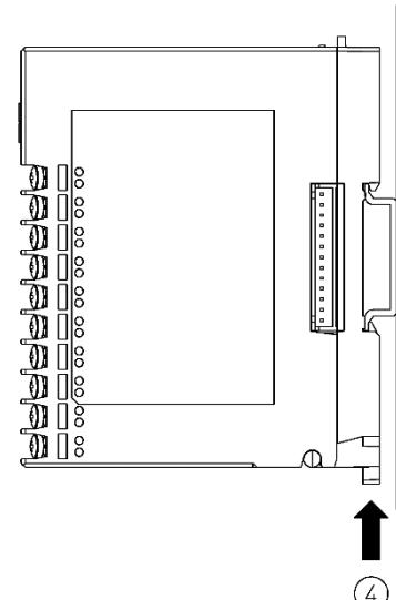
通信拡張モジュール QMC1 と制御モジュール QTC1-40 を DIN レールに取り付ける場合を例に説明します。
