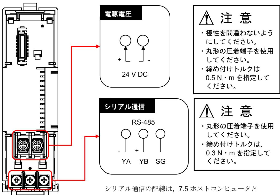
シリアル通信の配線は、7.5 ホストコンピュータと制御モジュール QTC1-4 の接続(P.7-8)を参照してください。
