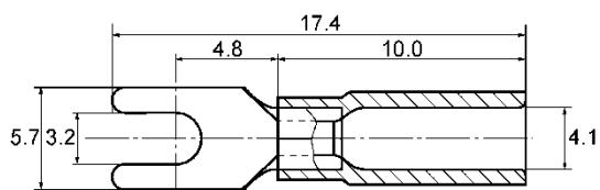
丸形圧着端子外形図(単位:mm)
