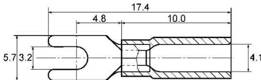
丸形圧着端子外形図(単位:mm)
