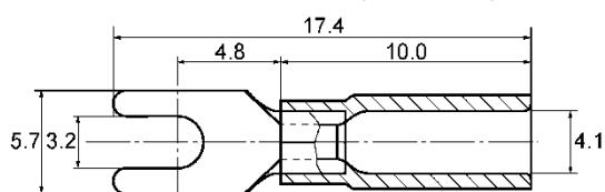
丸形圧着端子外形図(単位:mm)
