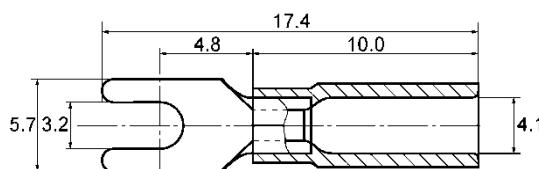
丸形圧着端子外形図(単位:mm)
