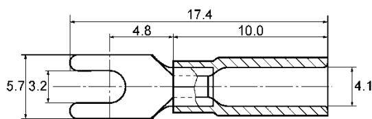
丸形圧着端子外形図(単位:mm)
