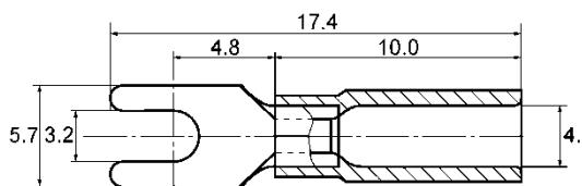
丸形圧着端子外形図(単位:mm)
