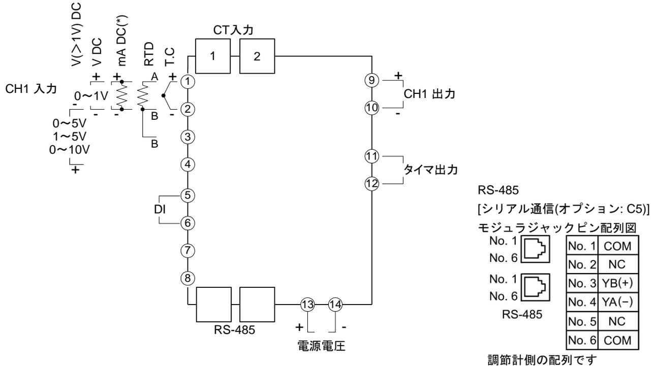
(\*): 直流電流入力の場合、入力端子間に別売りの受信抵抗器(50 Ω)を接続してください。
