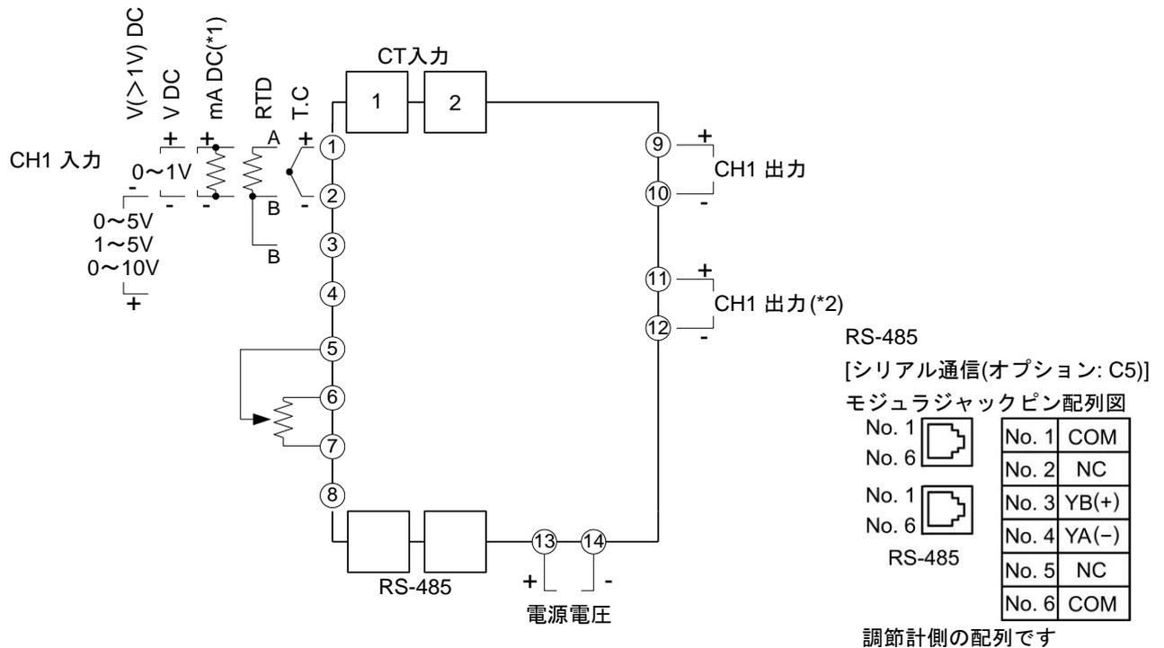
(\*1): 直流電流入力の場合、入力端子間に別売りの受信抵抗器(50 Ω)を接続してください。
