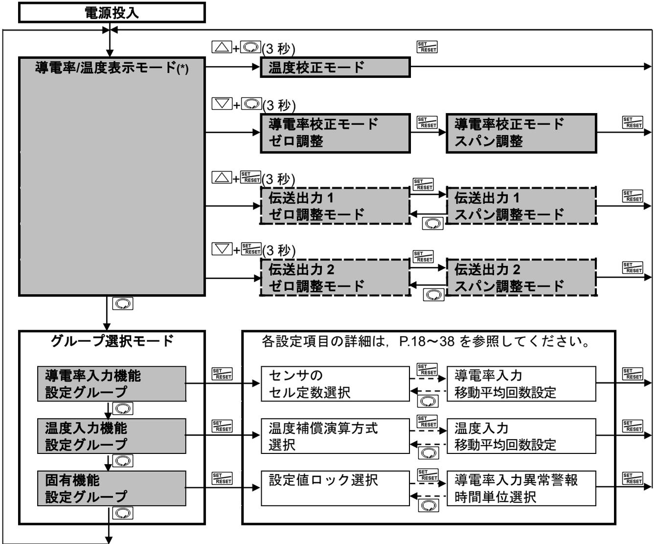
(\*): 導電率/温度表示モード時，[表示器選択(P.34)]で選択した項目を表示します。
